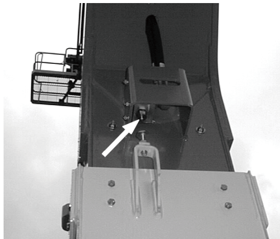
图 2-8. 塔臂水平限位开关。
